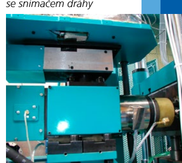
Vstříkovací tryska s PID regulací teplot
